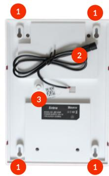
Branchez le câble noir à alimentation de la sirène en le faisant passer dans le trou prévu à cet effet sur votre façade. Emboitez la sirène dans les emplacements de vis et faites glisser la sirène vers le bas. Vérifiez que le bouton poussoir d'anti-arrachement soit bien appuyé contre le mur. Branchez l'alimentation sur une prise.
